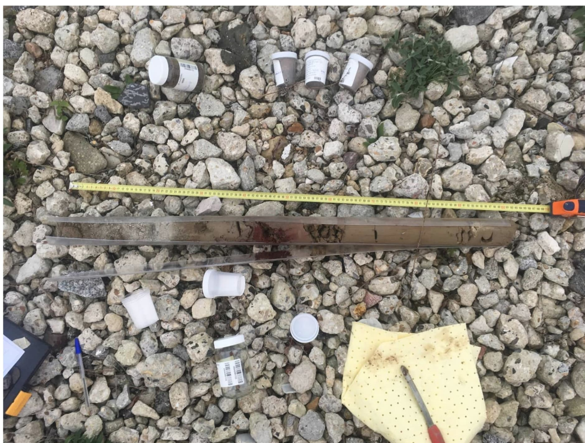
Photographie 3 : Présence de traces rougeâtres au droit du sondage RB18
